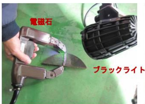
探傷例：極間式(蛍光磁粉)
